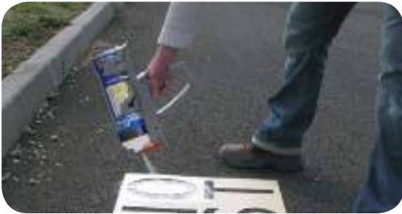
Marking pistol for X9M Paint Marker Markeerpistool voor X9M Paint Marker Pistolet de marquage pour X9M Traceur Chantier
